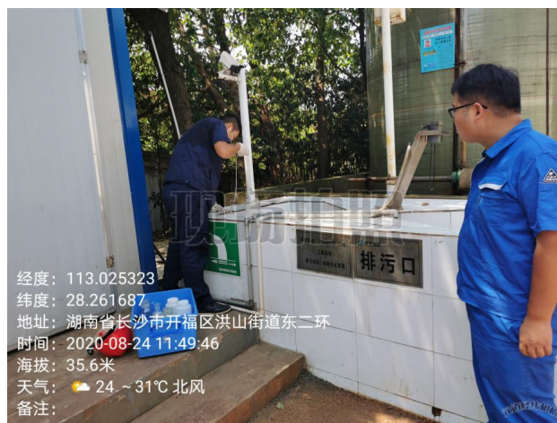
联合餐厨废水站排污口废水采样照片
